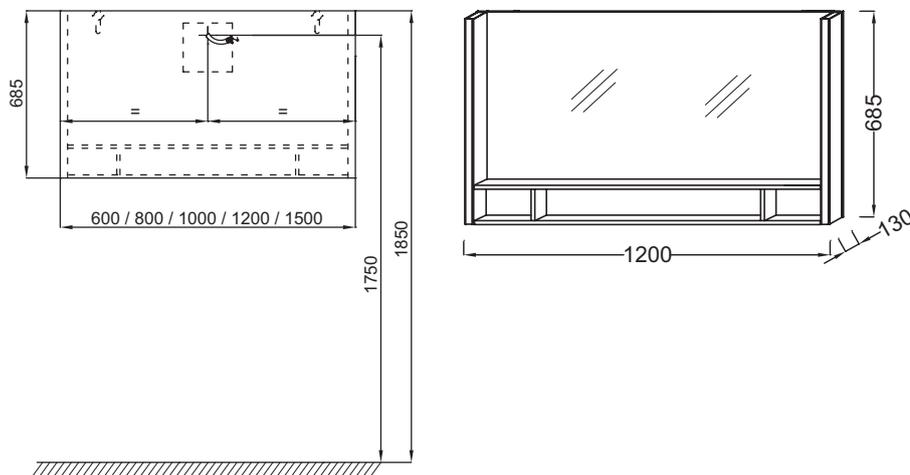
Спецификация продукта : Зеркало 120 см. EB1183. Коллекция : TERRACE. РАЗМЕРЫ (СМ) : 120 x 13 x 68.50 см. ВЕС : 21 кг. МАТЕРИАЛ : Лак или натуральное дерево. ТИП УСТАНОВКИ : Подвесная. ELECTRICITÉ : 230В, 14.4Вт, класс II, IP 44.
