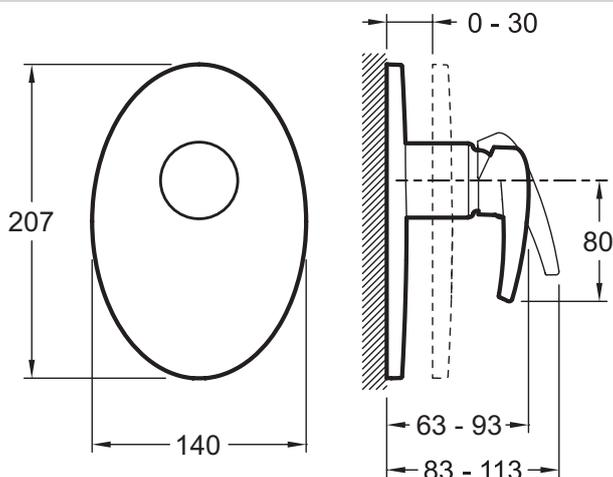
Спецификация продукта : Встраиваемый смеситель на 1 выход. E98704. Коллекция : PANACHE. ВЕС : 1.9 кг. МАТЕРИАЛ : N/A. Автоматический переключатель с функцией блокировки.
