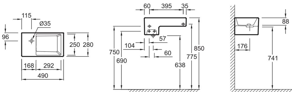
Спецификация продукта : Рукомойник 49 x 28 см. EGA012. Коллекция : TERRACE. РАЗМЕРЫ (CM) : 49 x 28 см. ВЕС : 10 кг. МАТЕРИАЛ : Санфарфор. ТИП УСТАНОВКИ : Подвесные или могут быть установлены вместе с мебелью. PERCEMENT ROBINETTERIE : 1 отверстием. CONFIGURATION : Стандартные. TROP-PLEIN : С отверстием перелива. LIVRÉ AVEC : С подсветкой по краю. ROBINETTERIE CONSEILLÉE : С расходом воды ниже 6 л/мин. Рекомендуемые смесители: с расходом воды менее 6 л/мин.
